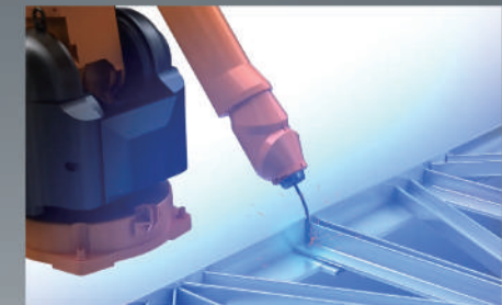
机器人焊接 Robotic Welding
